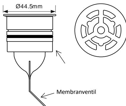
Das Whiffaway-Ventil, basierend auf einer patentierten Membrantechnologie, garantiert ohne den Einsatz von Strom, Sperrflüssigkeit oder anderer Zusätze den optimalen, geruchsfreien Abfluss. Die sichere Methode, den Verbrauch von Trinkwasser in Urinalen zu vermeiden und dadurch die Umwelt zu entlasten.
